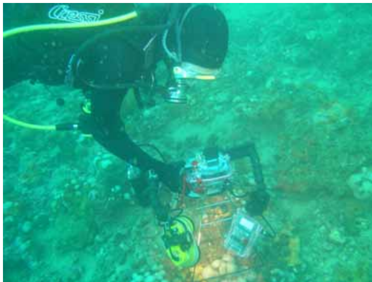
Figura 3.2 - Sistema fotografico digitale Olympus C-7070 con riquadratore e luce mista fari alogeni e flash TTL.
