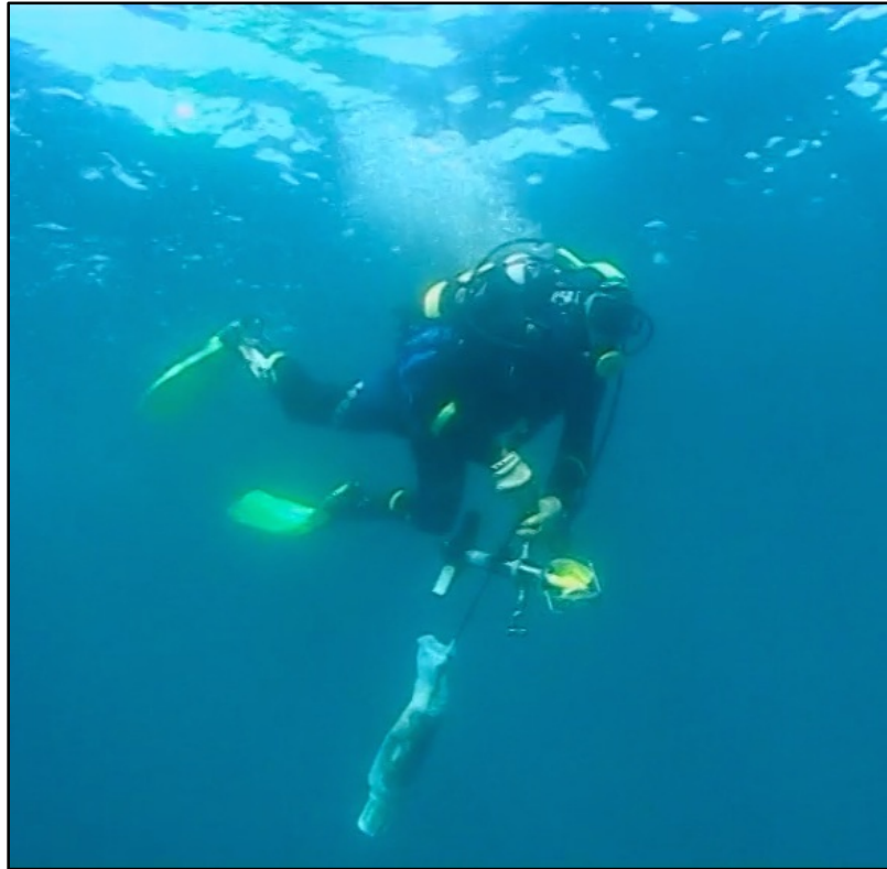
Mediante immersione subacquea, la strumentazione autoregistrante viene collocata al fondo della tagnù MR08.
