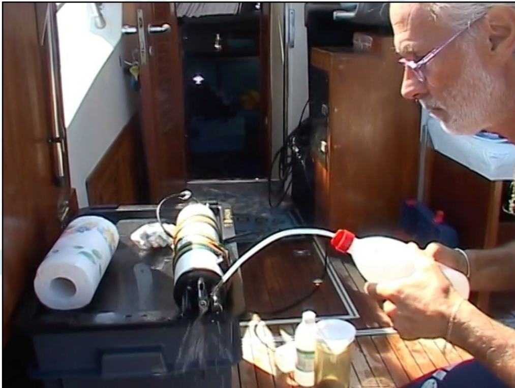
Preparazione e calibrazione della sonda multiparametrica a bordo.
